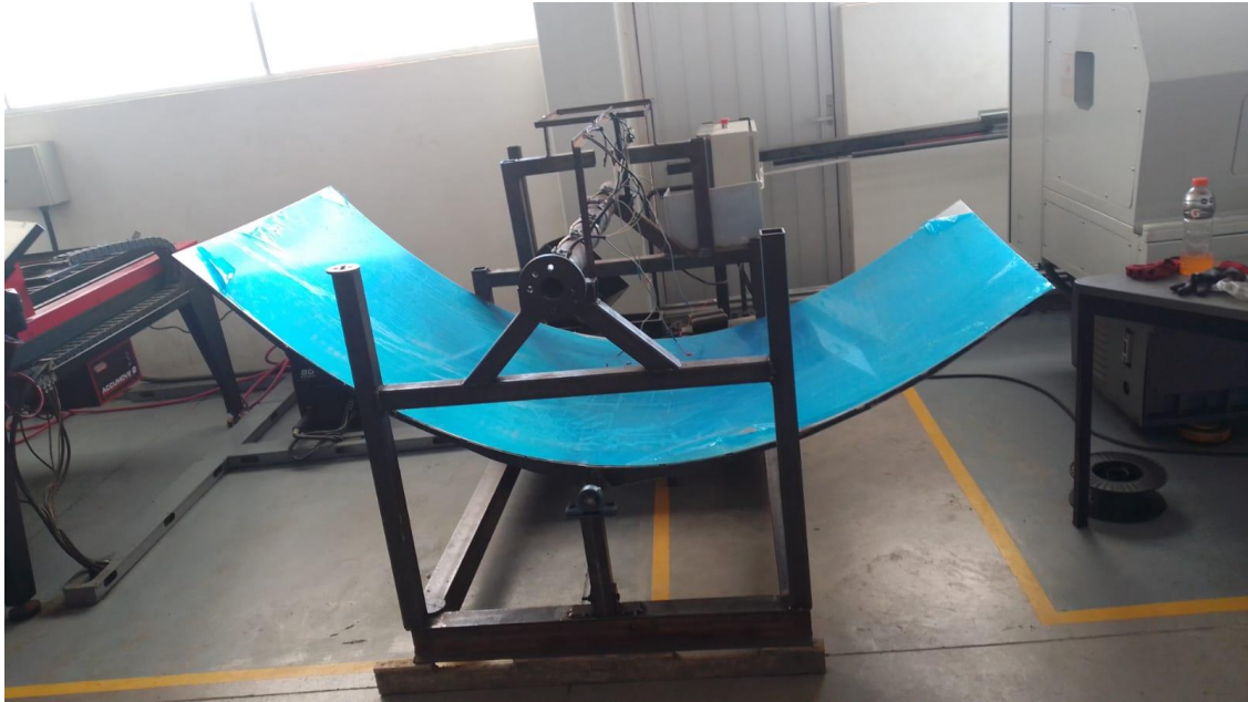
Figura 28. Concentrador construido integrado a máquina extrusora bajo sombra.
