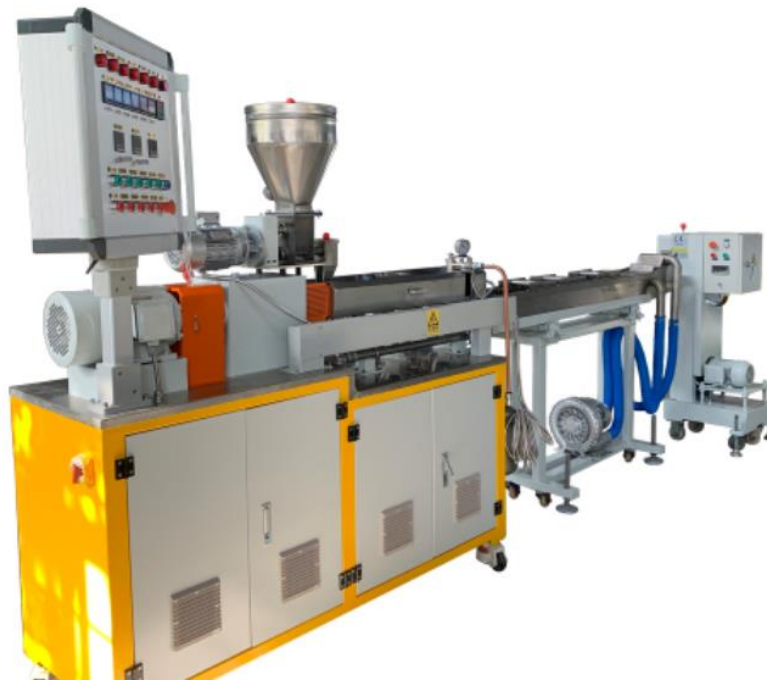
Figura 3. Máquina Extrusora CHT20 de plástico procesada [3].
