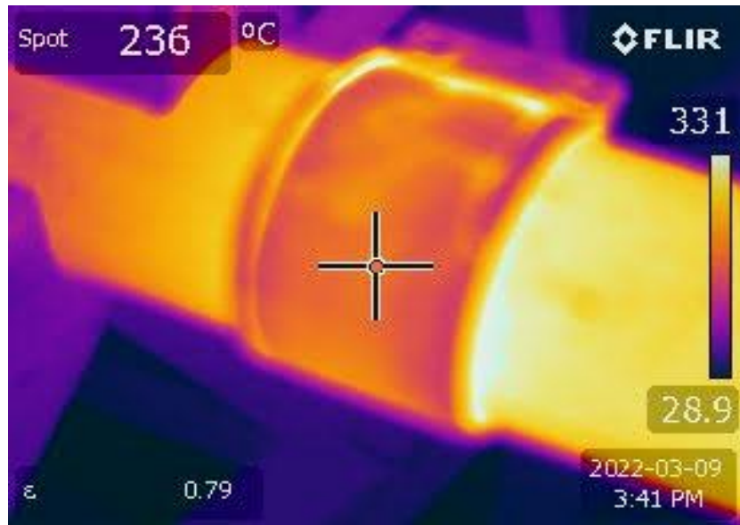
Figura 37. Resistencia bajo la cámara termográfica, en el sol.
