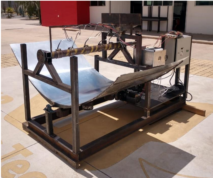
Figura 31. Concentrador construido integrado a máquina extrusora bajo el Sol.
