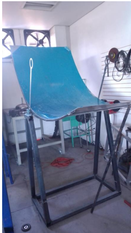
Figura 29. Concentrador construido de alojamiento externo a la máquina extrusora.
