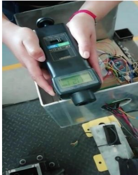
Figura 41. Medición de velocidad de giro del husillo con el tacómetro.
