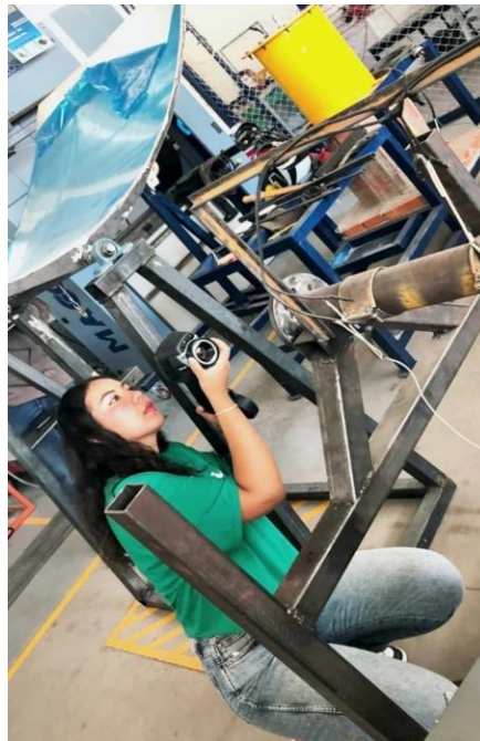
Figura 32. Toma de medición al Husillo con cámara termográfica.
