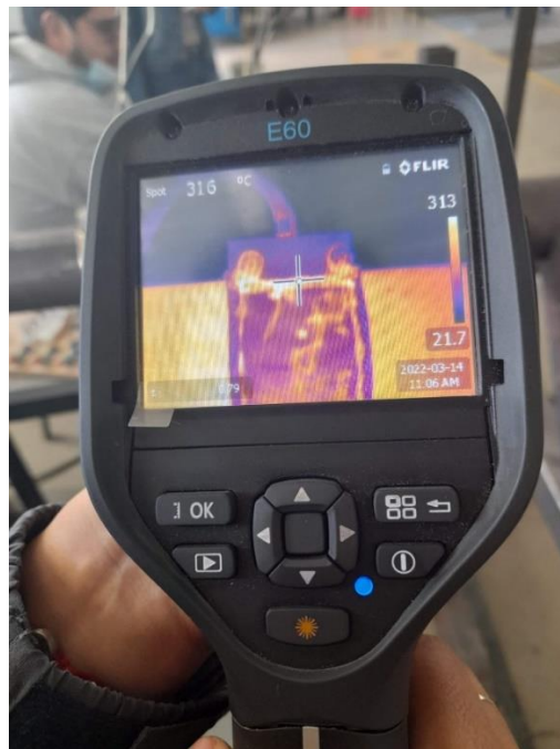
Figura 40. Midiendo la temperatura de la resistencia.
