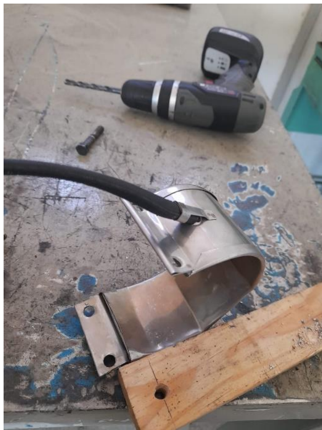
Figura 34. Ajustando la resistencia para el Tubo de la extrusora.
